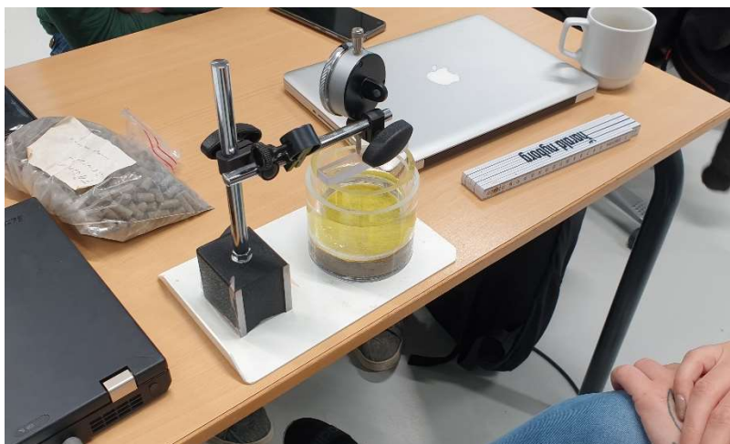
Figur 3: Forsøg med opkvældning af bentonit. Denne type forsøg er egnet til at give en konkret og hands-on erfaring med de forskellige materialer, der anvendes i forbindelse med borearbejde.
